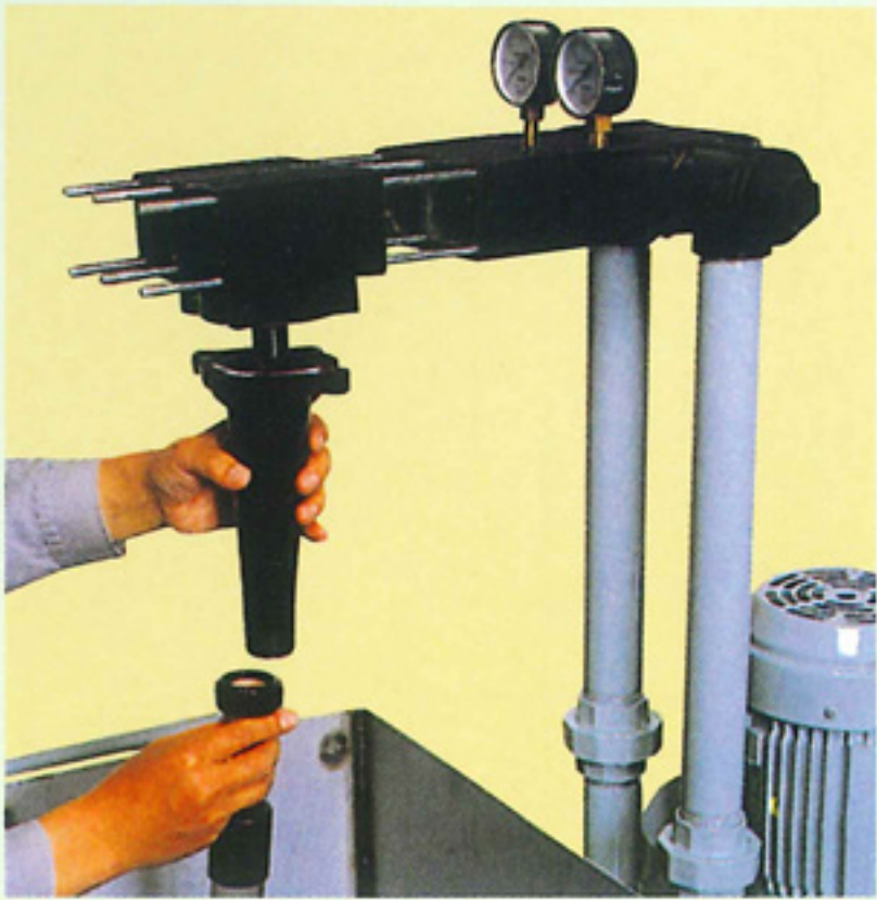
◀マニホールド・ノズルの分解 ▲逃し弁の分解 軽量でしかも取り外しが容易になり、メンテナンスが容易になりました。浄化効率の機能維持ができます。
