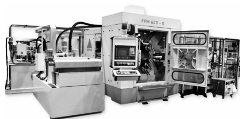
図4 FFM 機は後方フローフォーミングにより重量最適化されたリムリングを成形する。サイクルタイムは約12秒である。
