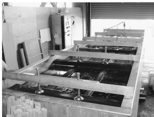
図5 不燃薬剤浸漬槽
